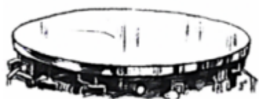
A. 4.03米大口径碳化硅反射镜
